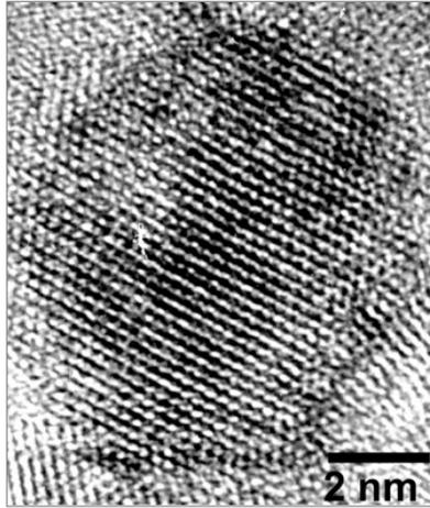
الشكل (6-3): صور مجهرية أُخذت بواسطة الميكروسكوب النافذ الإلكتروني عالي الدقة لحبيبة واحدة من حبيبات مادة كربيد التيتانيوم TiC حُضرت معمليا بواسطة مؤلف هذا الكتاب، وذلك عن طريق الحث الميكانيكي لتفاعل الحالة الصلبة Mechanically-Induced Solid-State Reaction بين مساحيق حبيبات الكربون والتيتانيوم، باستخدام طاحونة الكرات عالية القدرة. ومن الشكل نستطيع القول إن طريقة التحضير هذه توفر إنتاج حبيبات نانوية فائقة النعومة، تصل أقطارها إلى نحو 5 نانومترا<sup>(14)</sup>.
