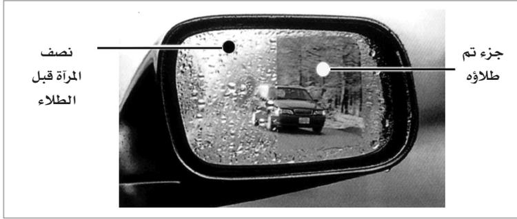
الشكل (8 - 3): صورة فوتوغرافية التقطت لمرآة جانبية، لإحدى السيارات إبّان سيرها في أثناء هطول الأمطار، طلي نصفها بطبقة رقيقة شفافة من مادة  $TiO_2$ ، بينما لم يُطل النصف الآخر، وذلك للمقارنة بين مدى وضوح الرؤية بالحالتين (11).
